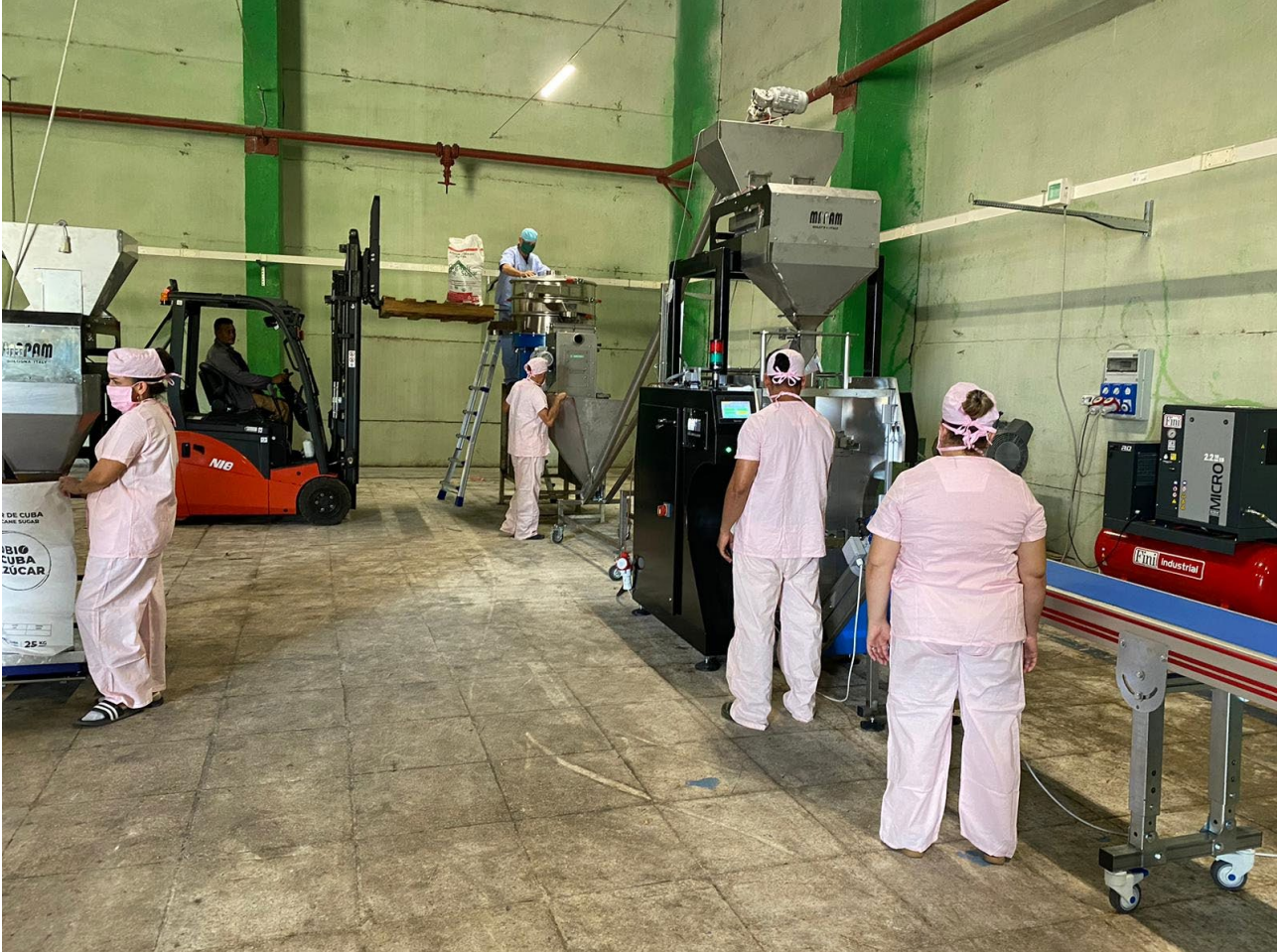
2. Da sinistra: Confezionatrice 25 kg in funzione, Muletto, Coclea + Vite senza fine, Confezionatrice 500 gr, Nastro Trasportatore
