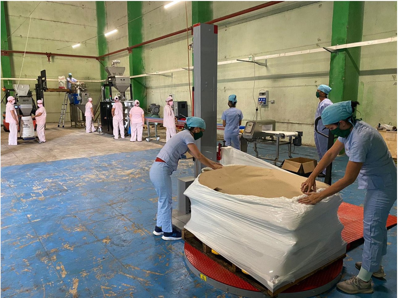
7. Linea Completa in Prospettiva: Confezionatrice 25 kg, Vibrovaglio, Deferrizzatore, Coclea, Confezionatrice 500 gr, Nastro Trasportatore, Metal Detector, Avvolgitore Pallet Automatico
